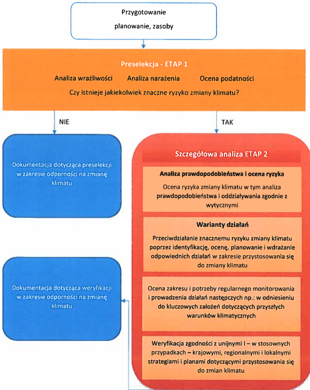
Rysunek 5. Schemat procesu oceny przystosowania się do zmiany klimatu na potrzeby weryfikacji projektów infrastrukturalnych
